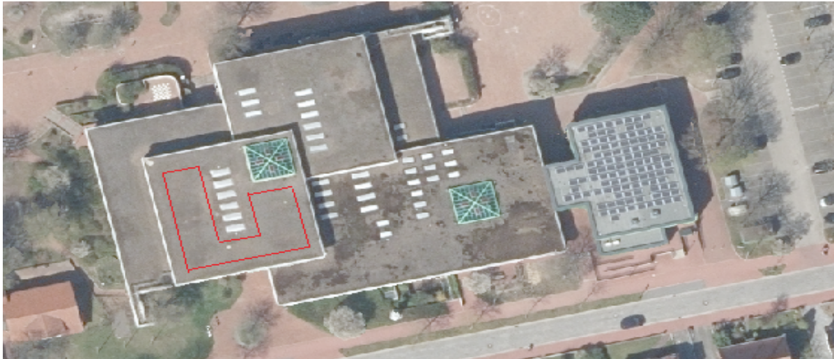
Zulässige Dachfläche ca. 360 m 2 für Erweiterung PV Anlage
