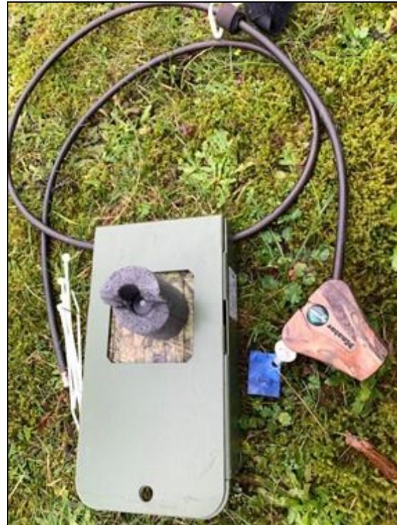
Abbildung 42: Aufbau eines Anabats mit Mikrofon-Schutz und Schloss
